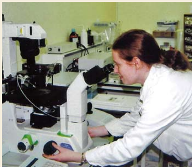
Laureline Berthelot microscope utilisé pour les microinjections d'ADN afin de créer des souris transgéniques.
